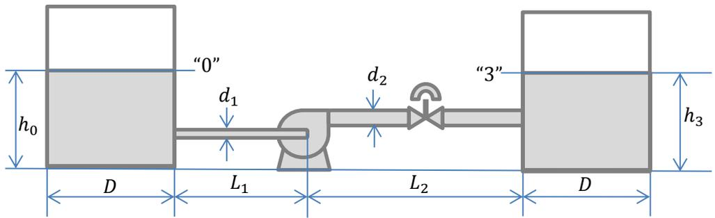
una funzione incognita della portata volumetrica,  $e_v = e_v(\dot{V})$ . Vengono eseguiti alcuni esperimenti, variando il grado di chiusura della valvola  $R$  ( $R = 0$  è la valvola completamente aperta,  $R = 1$  è la valvola chiusa) e misurando la portata volumetrica di acqua che circola. Durante gli esperimenti i livelli di liquido nel serbatoio vengono mantenuti costanti (aggiungendo acqua al primo e togliendone dal secondo), i risultati degli esperimenti sono nella tabella.
