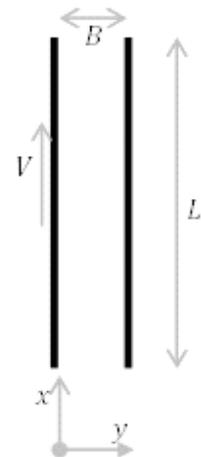
1. Determinare e disegnare i profili degli sforzi,  $\tau_{xy}$ , e della velocità,  $v_x$ , per questo sistema;
